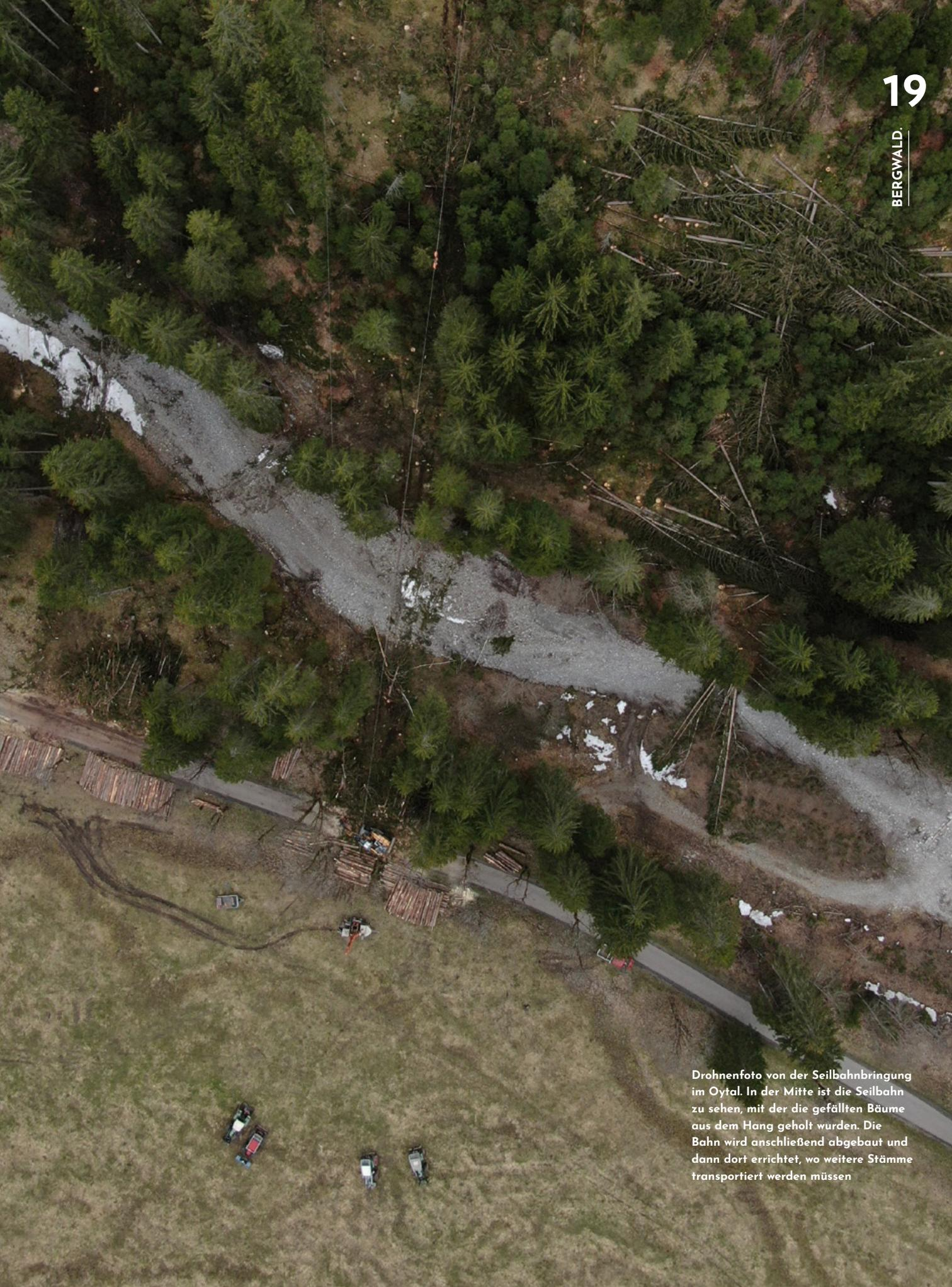
Drohnenfoto von der Seilbahnbringung im Oytal. In der Mitte ist die Seilbahn zu sehen, mit der die gefällten Bäume aus dem Hang geholt wurden. Die Bahn wird anschließend abgebaut und dann dort errichtet, wo weitere Stämme transportiert werden müssen
