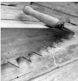
Doch für die Holzer im Allgäu brachte der Umstieg von Dreieckzahn-Sägen (oben) auf Hobelzahn-Sägen - eine Erfindung aus der Schweiz - eine deutliche Erleichterung ihrer schweren Arbeit. Bis dann Motor-Sägen aufkamen.
